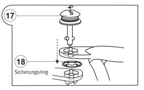
Zur Demontage des QUICK-LOCK-Kofferträgers einfach mit einer Münze oder einem Schraubendreher die Schnellverbinder lösen und Seitenträger entfernen.
