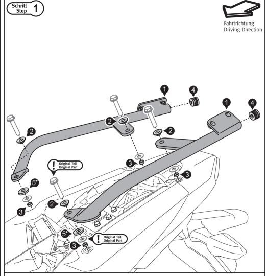
Entfernen Sie die Sitzbank und die originalen Haltegriffe vom Fahrzeug. Montieren Sie anschließend die Haltegriffe (1) wie gezeigt. Benutzen Sie für die Montage die originalen Schrauben und Unterlegscheiben. \*Die Distanzbuchsen (5) nur in Verbindung mit dem SW-MOTECH QUICK-LOCK Kontur-Kofferträger und QUICK-LOCK EVO Kofferträger verwenden.
