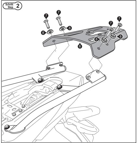
Verschrauben Sie das ALU-RACK (6) wie gezeigt. Sichern Sie alle Schrauben mit flüssiger Schraubensicherung. Anzugsmoment für die Schrauben (7): 20 Nm.
