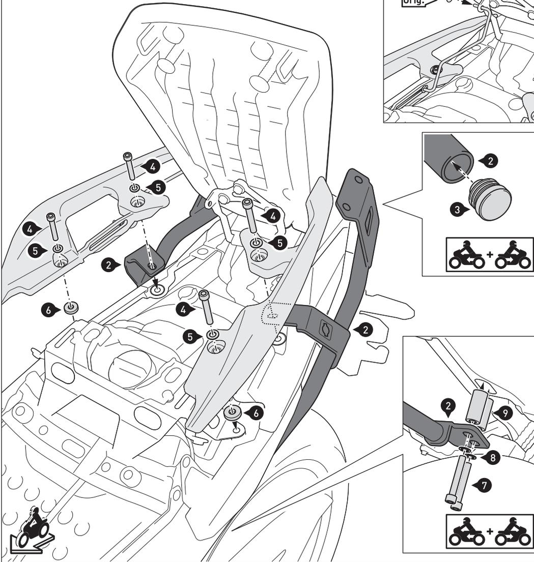
Setzen Sie die Kunststoffstopfen (3) in die Enden der Anbaustreben (2) ein, wie in der mittleren Detailzeichnung gezeigt.
