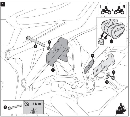
Montieren Sie die gezeigten Teile an den Sozius-Fußrastenhaltern (linke Fahrzeugseite gezeigt). Entnehmen Sie die Klickverschlüsse Ihren Satteltaschen.
