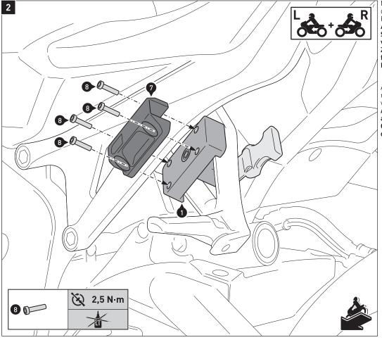
Montieren Sie die gezeigten Teile an den Befestigungsblöcken [1] (linke Fahrzeugseite gezeigt). ACHTUNG: Ziehen Sie die
